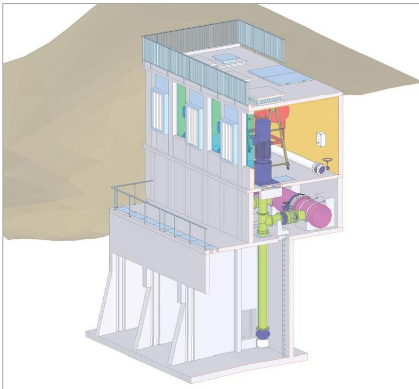
Figure 31 : Plan et coupe 3D de l'ouvrage d'exhaure de l'usine Vilaine Atlantique
