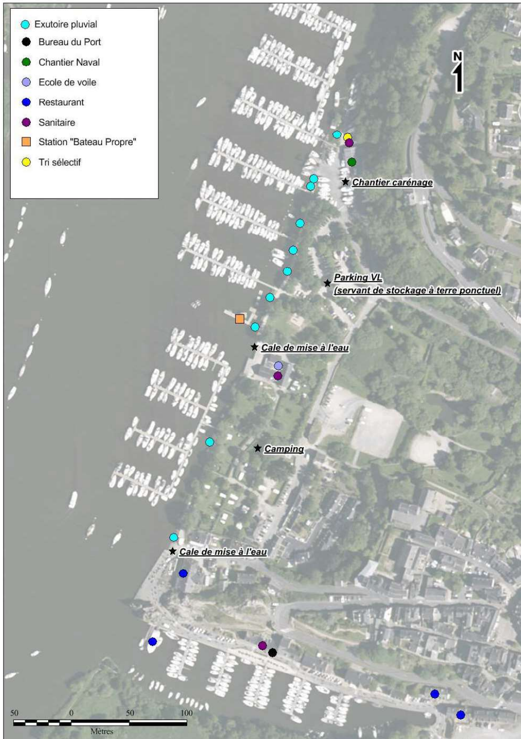
Figure 24 : Installations identifiées et réseaux d'eaux usées / pluviales sur le port de la Roche Bernard
