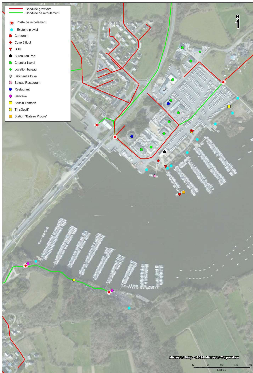
Figure 22 : Installations présentes et réseaux d'eaux usées / pluviales sur le port d'Arzal-Camoel
