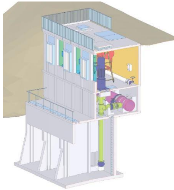
Illustration n°3 et 4 : vue aérienne de l'installation de pompage et coupe en 3D de l'ouvrage d'exhaure de l'usine de production d'eau potable de Vilaine Atlantique. Source : rapport de présentation pp.73 et 77
